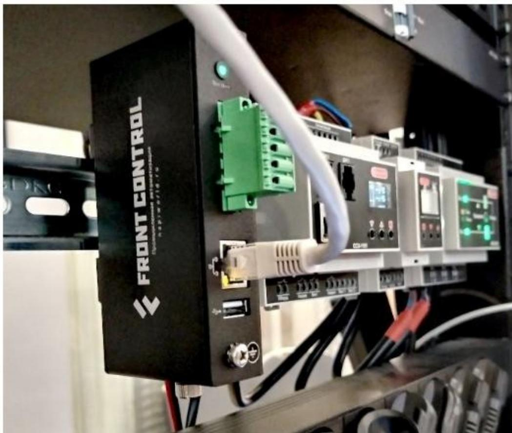
FGM-0801 является прозрачным шлюзом Modbus RTU — Modbus TCP с функцией хранения и мониторинга данных. Монтируется на стандартную DIN-рейку. Настройки шлюза и мониторинга данных осуществляются через Веб-интерейс.
