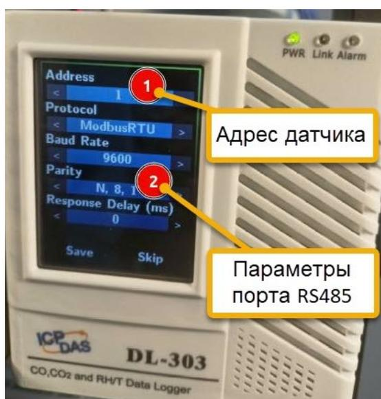
Рис. 7.6. Настройка адреса датчика ICPDAS DL-303 и параметров порта RS485
