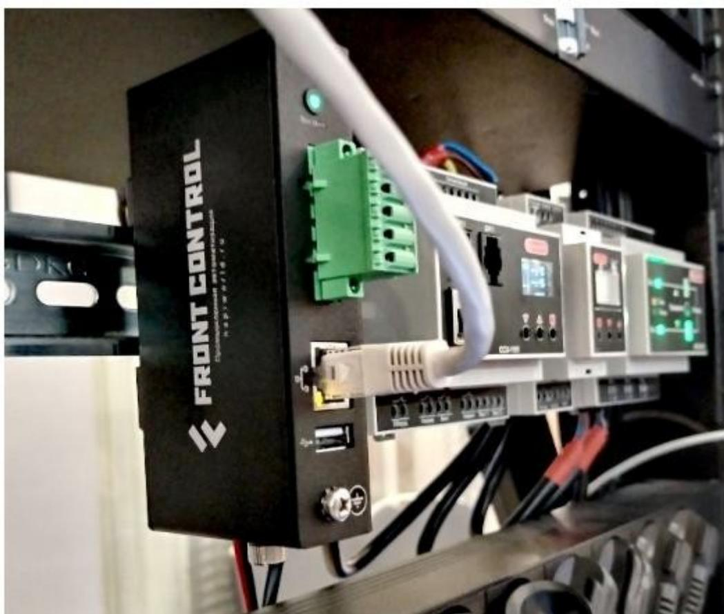
**FCC-0801** — это суперкомпактный одноплатный компьютер на базе модуля Nari-C, работающий под управлением Linux (Armbian или NariLinux). Хорошо подходит для промышленных и автоматизированных решений.
